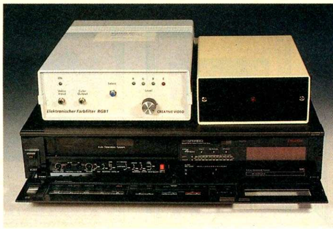
Bild 3. Der Digitizer VD-3 und der RGB-Splitter von Merkens mit dem NV-D80 von Panasonic
